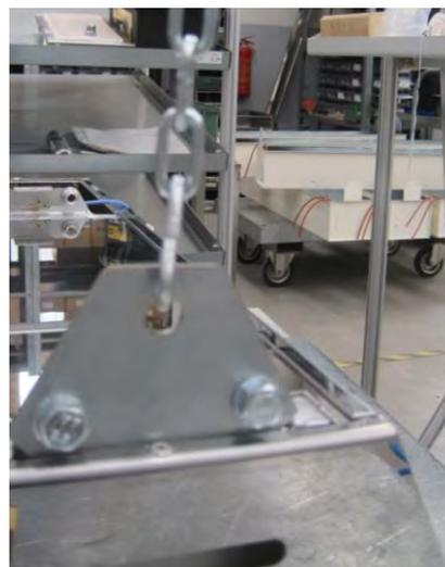
Figura 2 – Fissaggio con catenelle **serie D-RAD**
