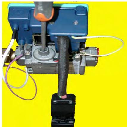
**Solo in caso di manutenzione**, su istruzione di personale qualificato SIABS, è possibile modificare le pressioni di taratura, eseguendo la seguente procedura:
